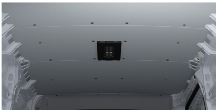
Obložení vnitřní strany střechy, 1 ks, instalace 1,2 h
