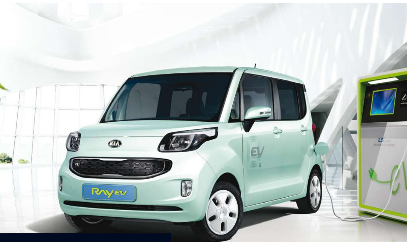
Kia Ray První sériově vyráběné vozidlo v Koreji s deklarovaným dojezdem 139 km na jedno dobíjení, kterou zajišťovala vysokonapěťová baterie s kapacitou 16,4 kWh.
